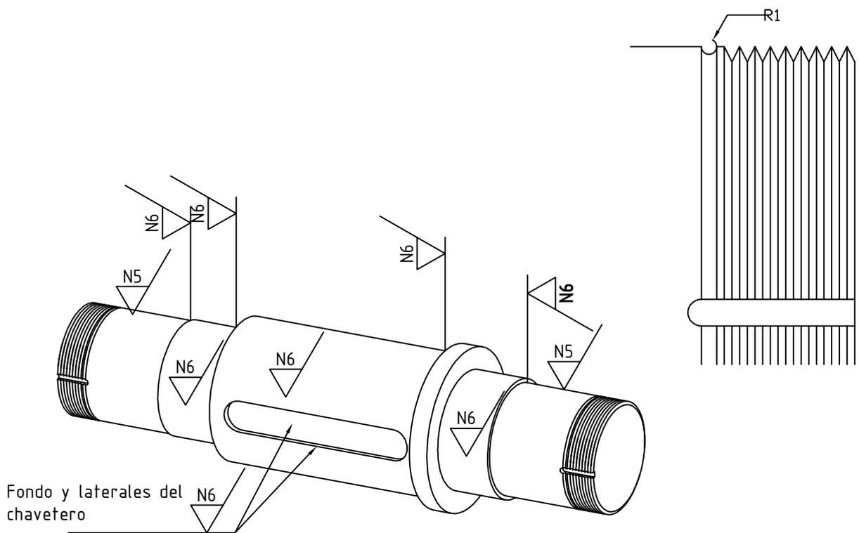
\* Completar el croquis de la pieza con la/s vista/s, corte/s, sección/es necesarias para poder construir la pieza.
