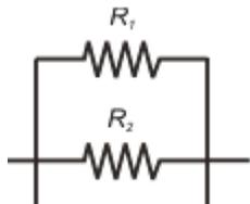
combinada (o equivalente)  $R$  está dada por la fórmula:  $R = \frac{R_1 \cdot R_2}{R_1 + R_2}$ .
