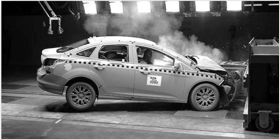
Los **crash tests**, o **pruebas de choque de automóviles**, son un paso imprescindible en el desarrollo de cualquier vehículo que se lanza al mercado hoy en día ya que a través de este tipo de prueba se puede clasificar la seguridad de un tipo determinado de vehículo.
