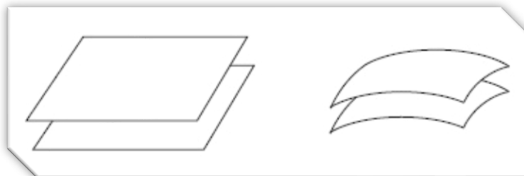
Figura 1.9: Planos de referencia en Topografía (izq.) y superficies en Geodesia (dcha.)
