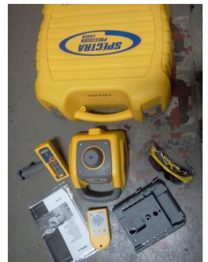
Figura 2.35 A: Nivel laser
