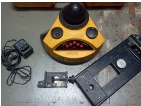
Figura 2.35 B: Nivel laser
