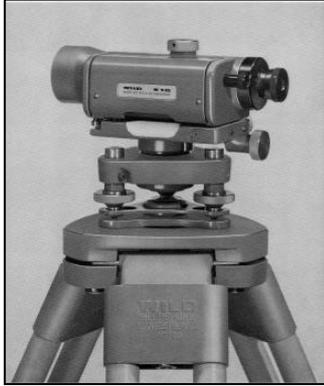
**Figura 4.34:** Nivel de anteojo fijo- nivel fijo. Con tornillo de elevación
