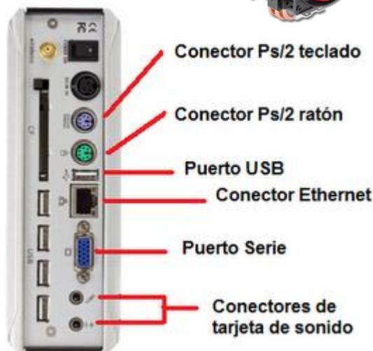
El USB (Universal Serial Bus) es un puerto de gran velocidad para comunicar computadoras y periféricos. Un sólo puerto USB permite ser usado para conectar más de 127 dispositivos periféricos como ratones, módems, teclados, impresoras, etc. Prácticamente reemplazó a los puertos serial y puertos paralelos.
