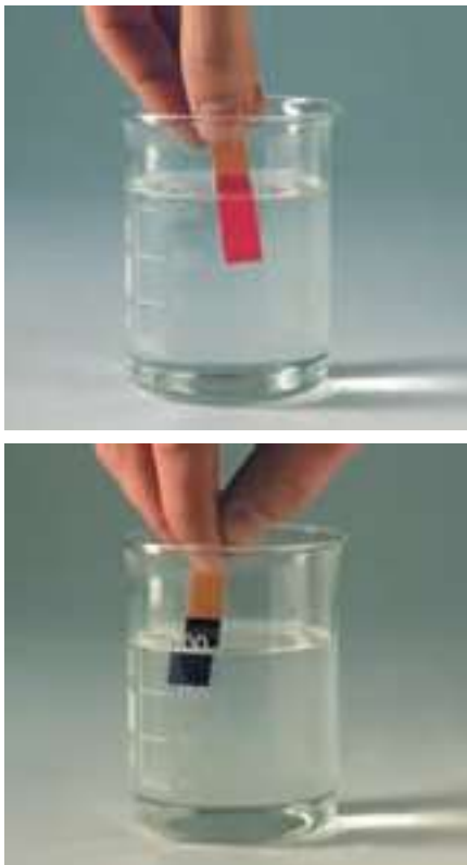
Figura 12. Los ácidos y las bases se pueden diferenciar porque modifican el pH de las soluciones acuosas. a) Se muestra un ácido, que colorea de rojo el papel de tornasol. b) Se muestra un hidróxido, coloreando de azul el papel de tornasol.
