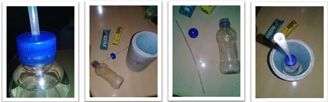
Para armar el termómetro necesitamos una botellita o frasco pequeño puede ser de plástico o de vidrio, un tubito transparente (el mejor es el de los sifones plásticos de soda de 2 litros o más), sellador o pegamento (NO utilizar plastilina), agua coloreada (mezcla de agua y alcohol puede ser) y recipiente térmico.
