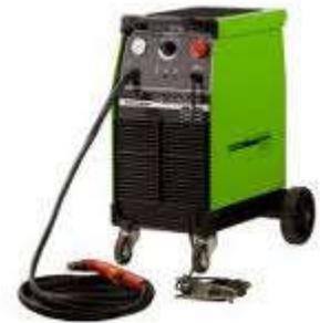
El equipo necesario para aportar esta energía consiste en un generador de alta frecuencia alimentado de energía eléctrica, aire comprimido provisto de un compresor, y un porta electrodos y electrodo que puede ser de tungsteno, hafnio, circonio o bronce.
