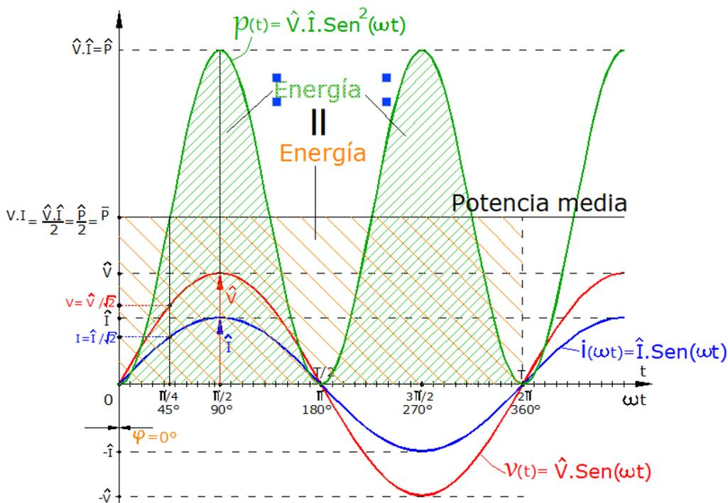
El área debajo de la función de potencia representa la energía consumida en un período, por el resistor (tramado verde), debe ser igual al área debajo del valor constante que representa la potencia media (tramado anaranjado).
