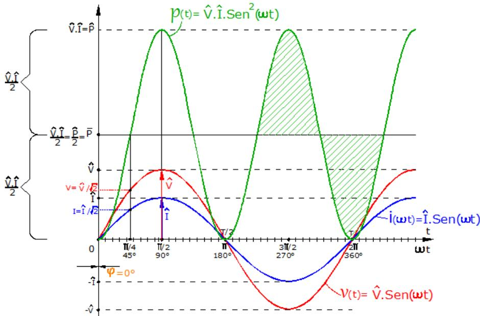
Fig. 3: Función de potencia en un resistor puro.
