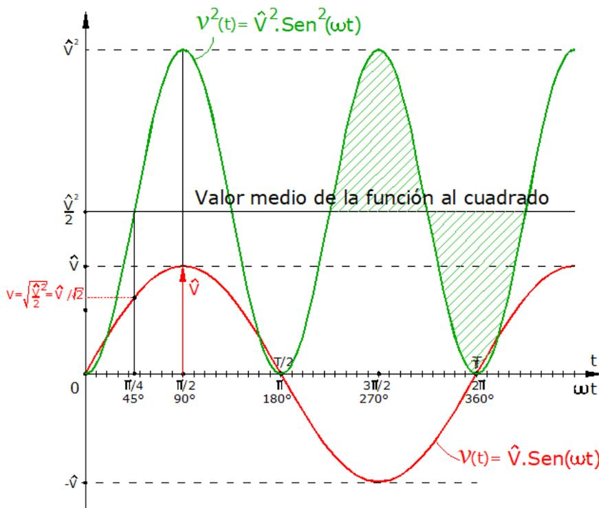
Fig. 4: Función de tensión al cuadrado, proporcional a la potencia.
