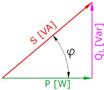
Triángulo de potencia de un circuito capacitivo
