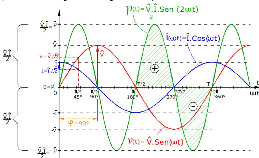
Fig. 8: Función de potencia en un capacitor puro.
