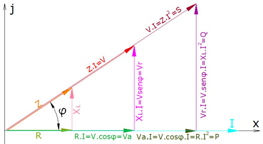
Deducción del triángulo de potencias partiendo del triángulo de admitancias (para R-L en paralelo)
