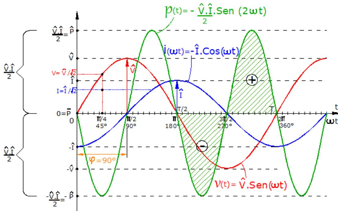
Fig. 6: Función de potencia en un inductor puro.
