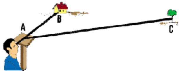
*Figura 5.3:* Medición de un ángulo entre dos puntos
