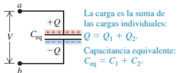
Fig. 18: Capacitores en paralelo y su equivalente.
