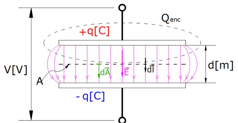
Fig. 10: Capacitor de placas paralelas(vista lateral en corte)
