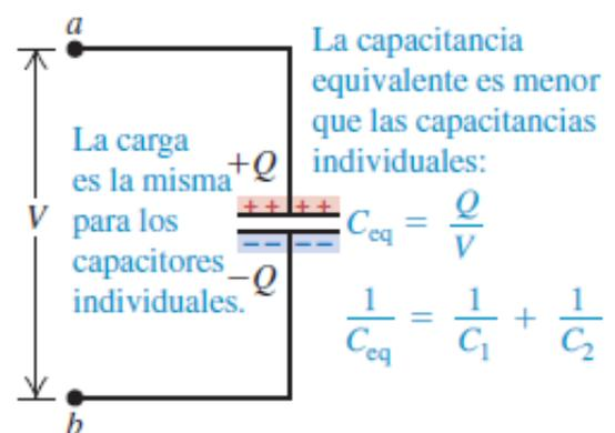
Fig. 19: Capacitores en serie y su equivalente
