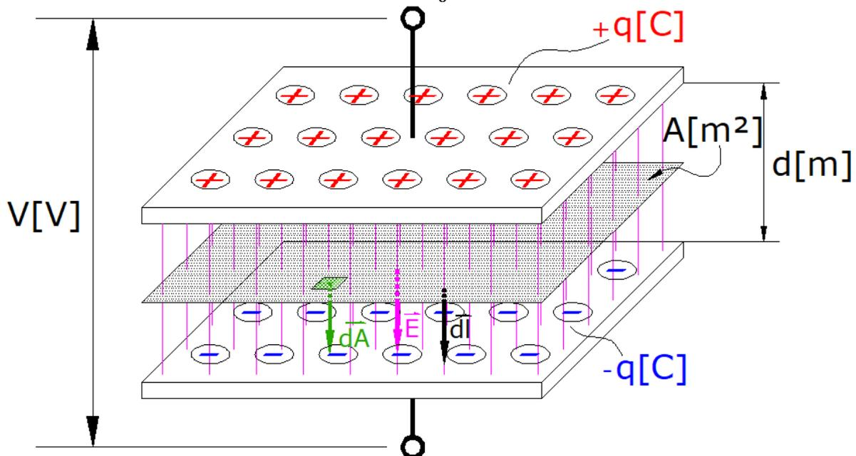
Fig. 9: Capacitor de placas paralelas.
