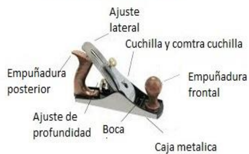
Partes de un cepillo manual de madera
